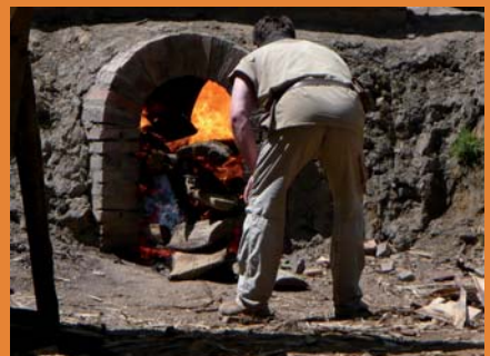
Le four est alimenté avec les chutes de bois du chantier.
