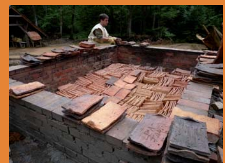
Le défournement des tuiles.
