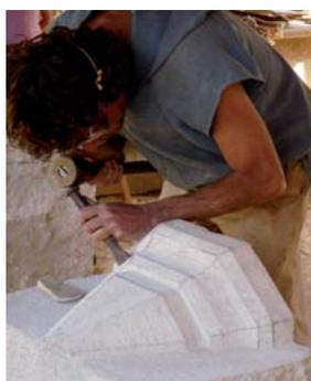
3 Les différentes parties du culot apparaissent et les moulures prennent forme. La taille devient de plus en plus précise.
