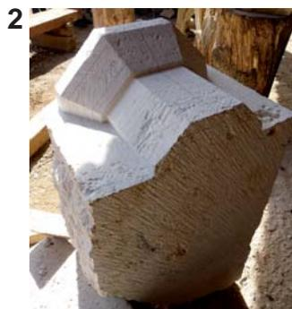
2 Le bloc est épannelé (= enlever de la matière pour dégager la forme du sujet) et la partie supérieure du culot se dessine.
