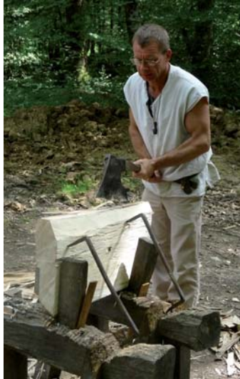
Equarrissage d'une pièce du moulin
