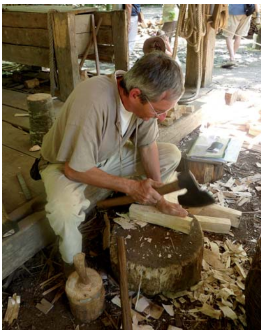
Les 29 alluchons en charme sont dégrossis à la doloire.
