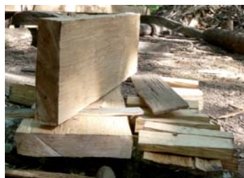
▲ Plateaux dans lesquels vont être taillés les deux pignons et les alluchons.
